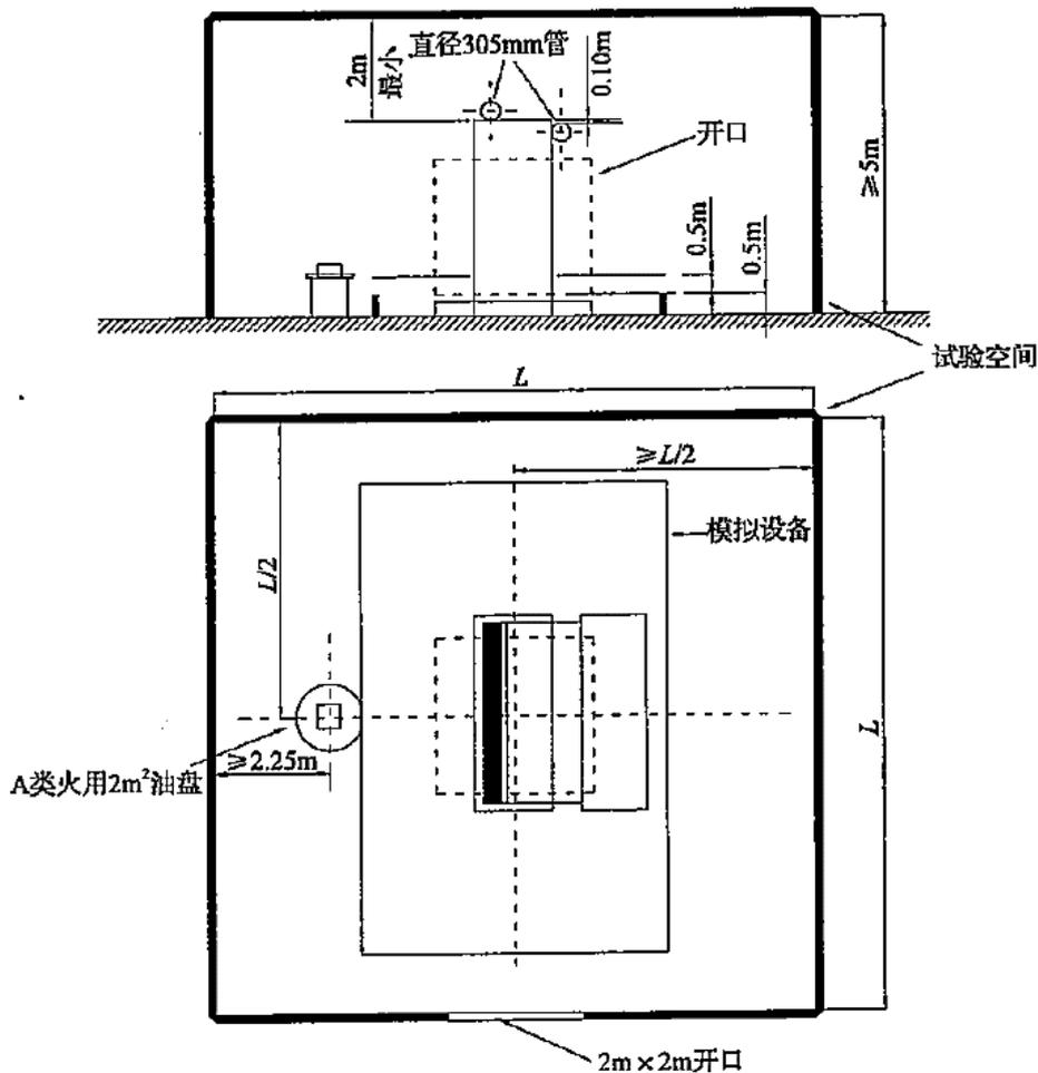
图 A.3.2-1 试验空间和设备模型
