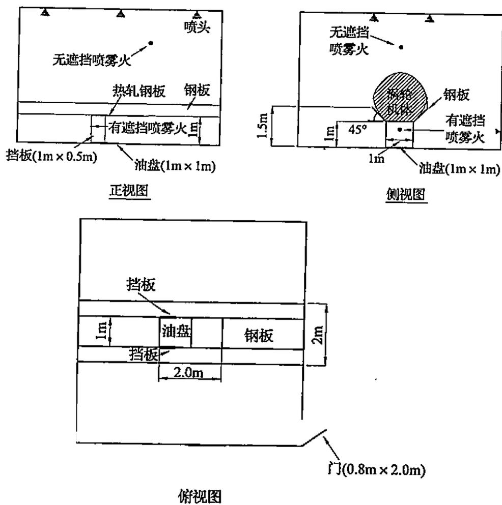
图 A.2.9 试验空间和涡轮机模型
