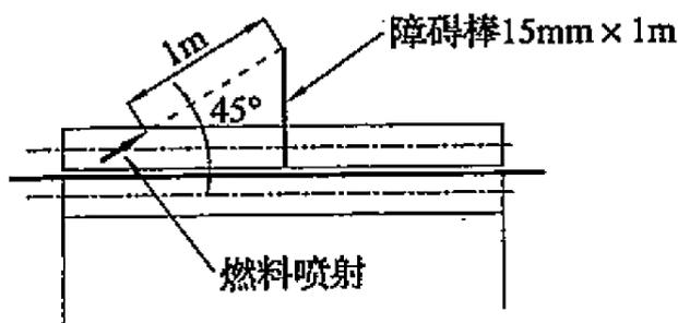
图 A. 3. 4 倾斜喷雾火的喷嘴布置位置
