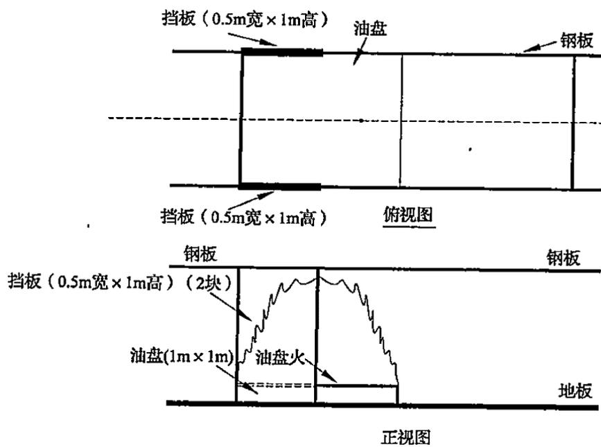
图 A. 2. 4-2 火源和遮挡油盘火布置
