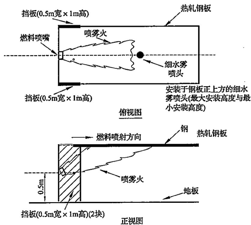
图 A. 2. 11-1 喷雾冷却试验布置
