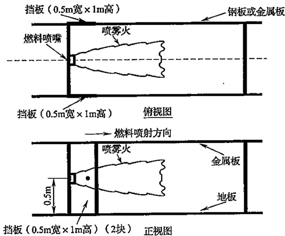
图 A. 2. 4-1 火源和遮挡喷雾火布置
