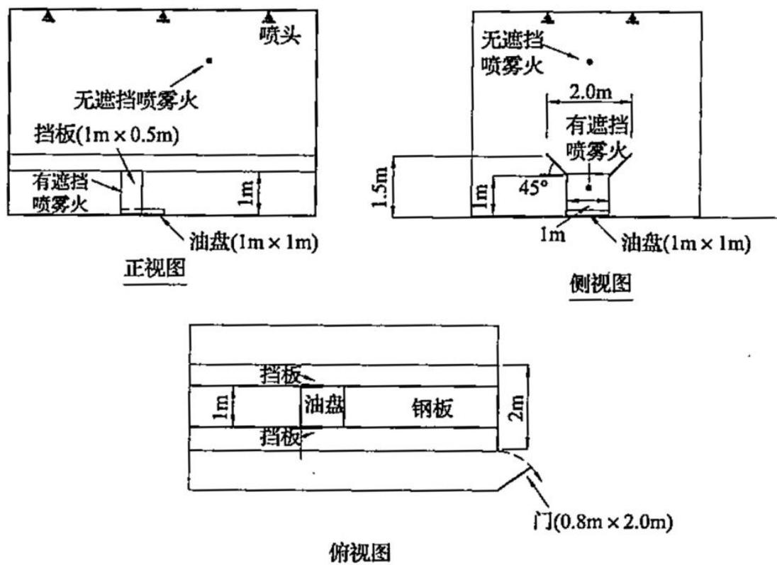
图 A.2.2 试验空间和设备模型
