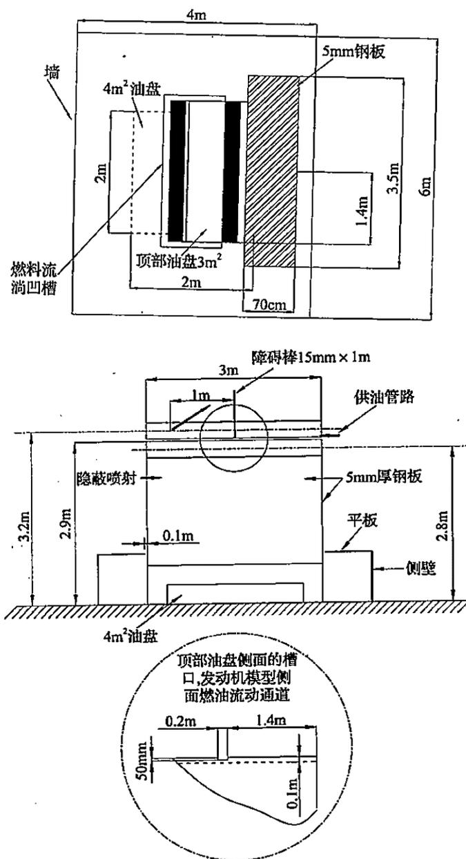
图 A. 3. 2-2 设备模型和试验设施布置
