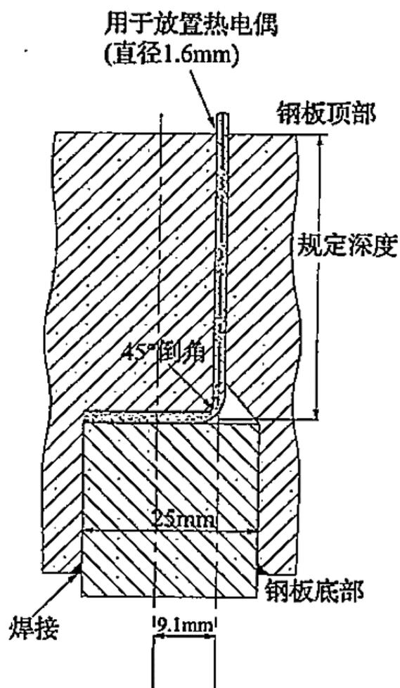
图 A. 2. 11-2 喷雾冷却试验热电偶布置
