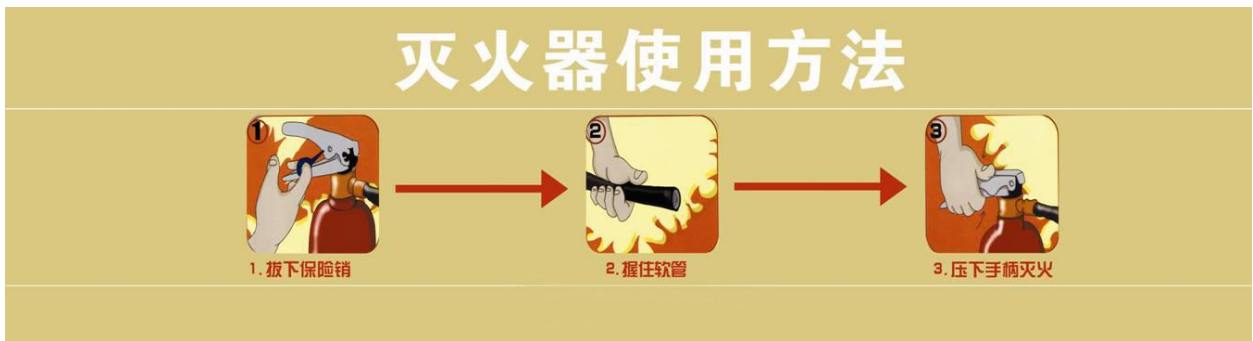
图A.1 灭火器使用方法
