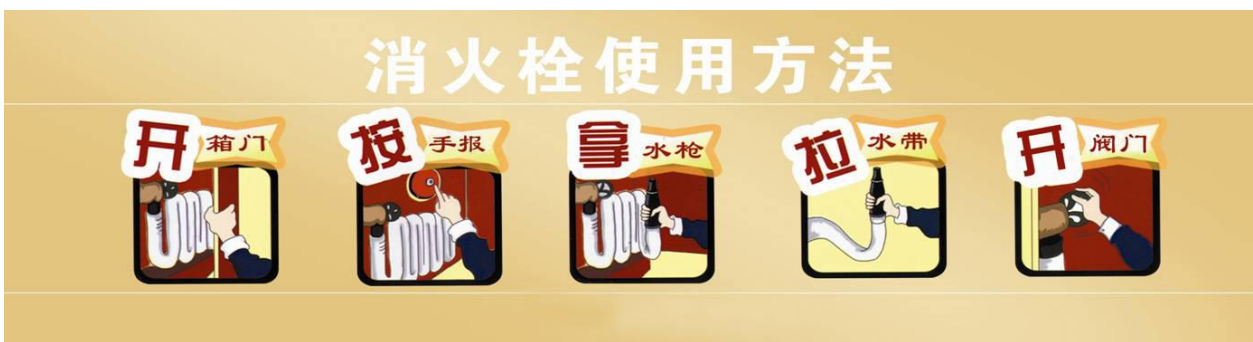
图A.2 消火栓使用方法
