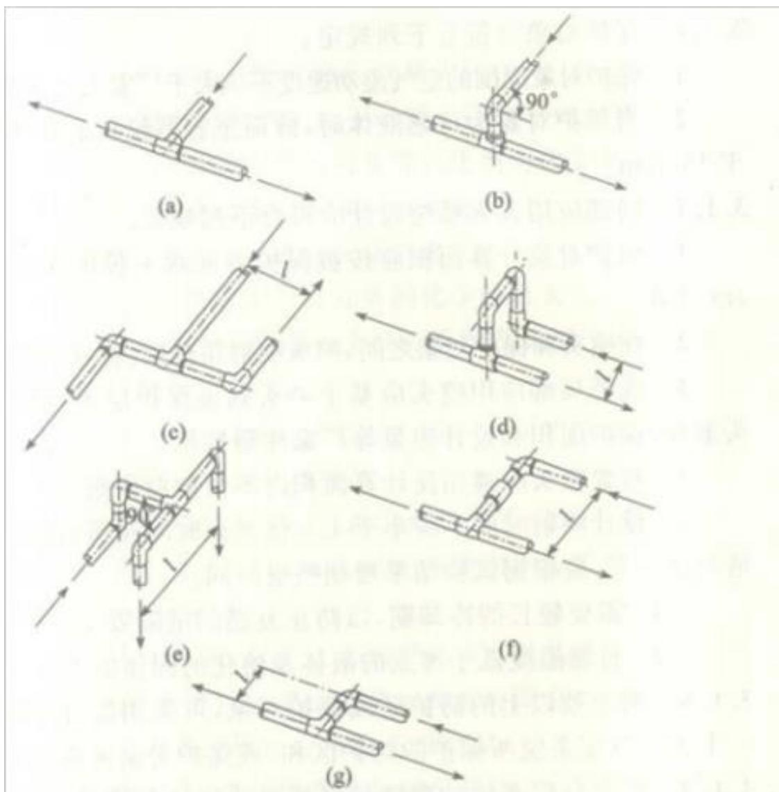
图 3.1.11 管网分支结构
