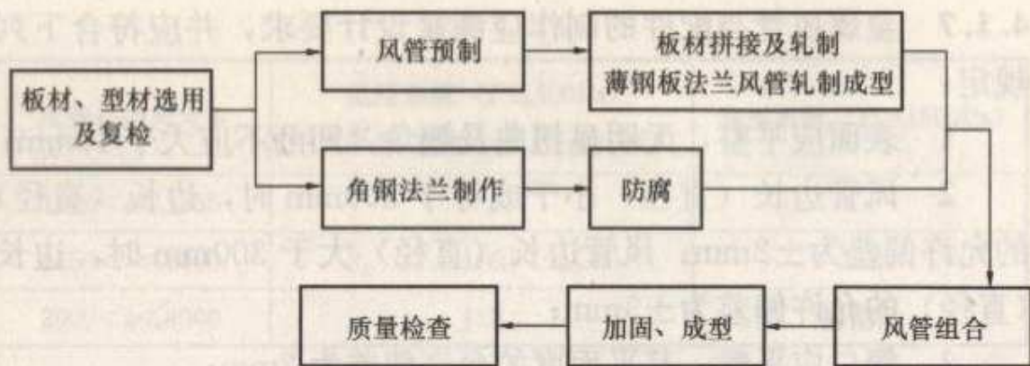
图 4.2.1 金属风管制作工序
