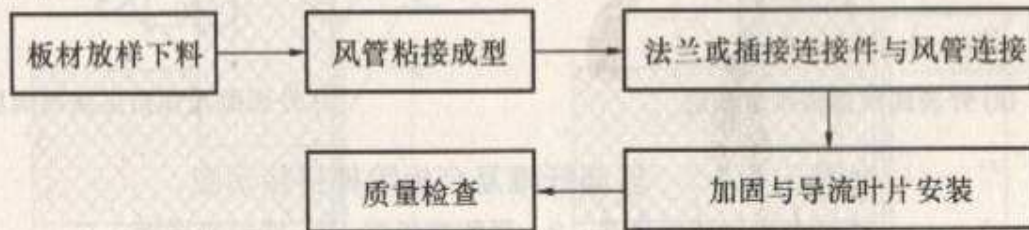
图 5.3.1 玻璃纤维复合风管与配件制作工序
