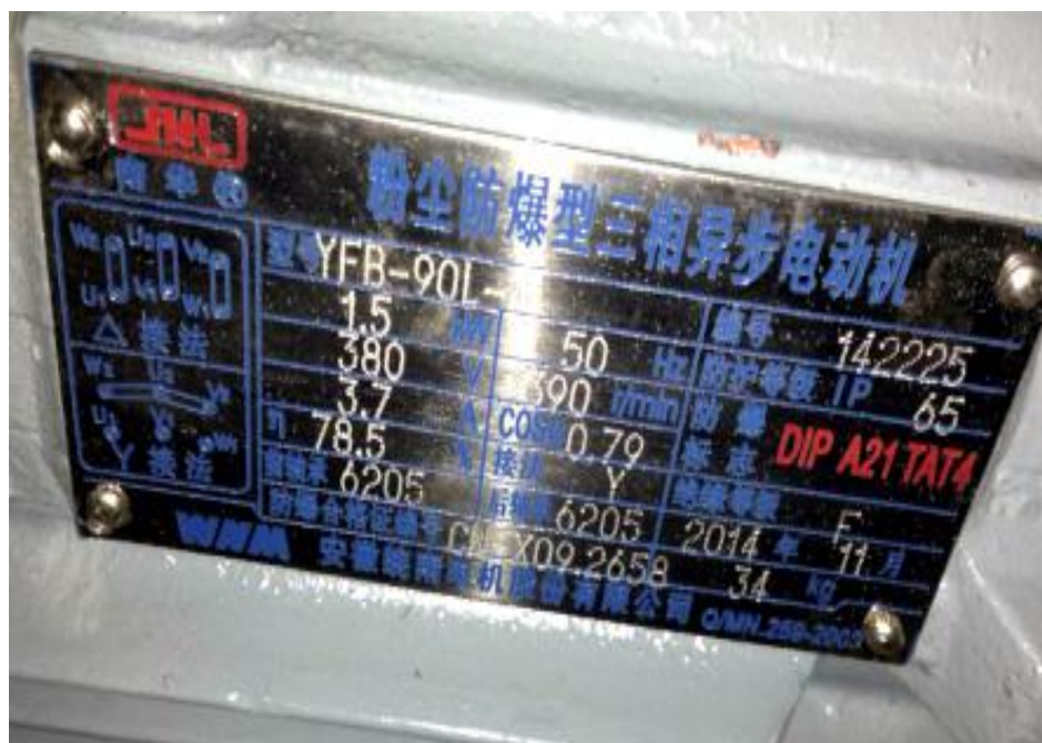
情景描述：粉尘防爆电机等电气设备的铭牌。
