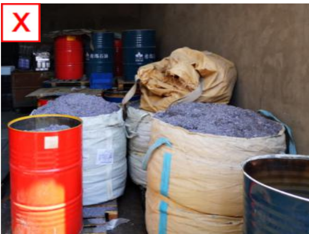
苏安办〔2020〕13号要求：应使用防锈蚀材料制作、开口的或透气的容器，临时存放高镁粉尘、高镁切削屑以及铝粉尘。 隐患描述：高镁合金废屑的收集、存放等环节未落实防水防潮、通风、氢气监测等必要的防爆措施；高镁合金废屑存放场所未配置合适的灭火设备。铝屑储存在铁桶中，且储存点无氢气监测设施。
