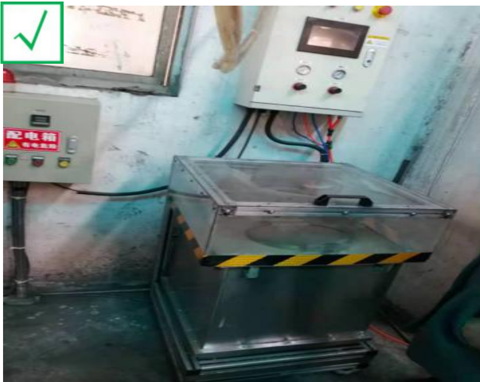
情景描述：铝镁制品机械加工除尘系统的惰化系统称重装置，并与除尘系统的控制装置保护联锁。
