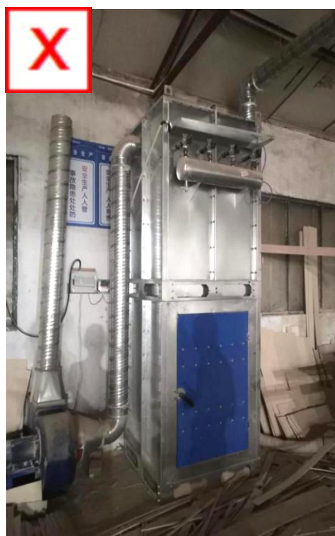
重大隐患描述：木粉尘除尘系统无任何控爆措施。
