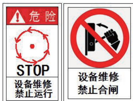
图 B.13 维修期间危险的安全标志
