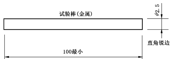
图 35 检验沟槽、孔及反向锥度用的量规
