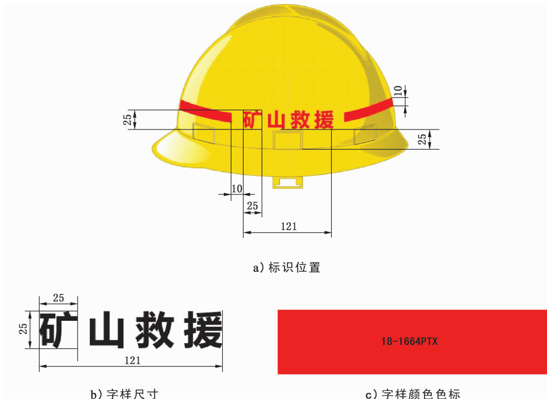
图 3 矿用安全帽标识位置、尺寸及颜色
