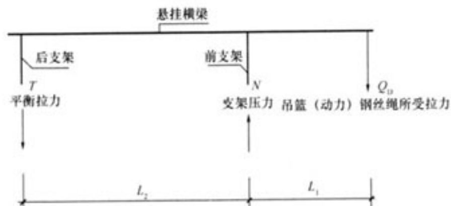
图 1 移动式悬挂支架的受力分析示意图
