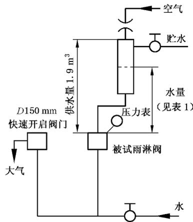
图 3 防复位试验
