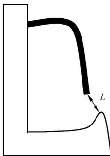
图1 座椅前部拦挡结构与压杠前端之间的最小距离 $L$
