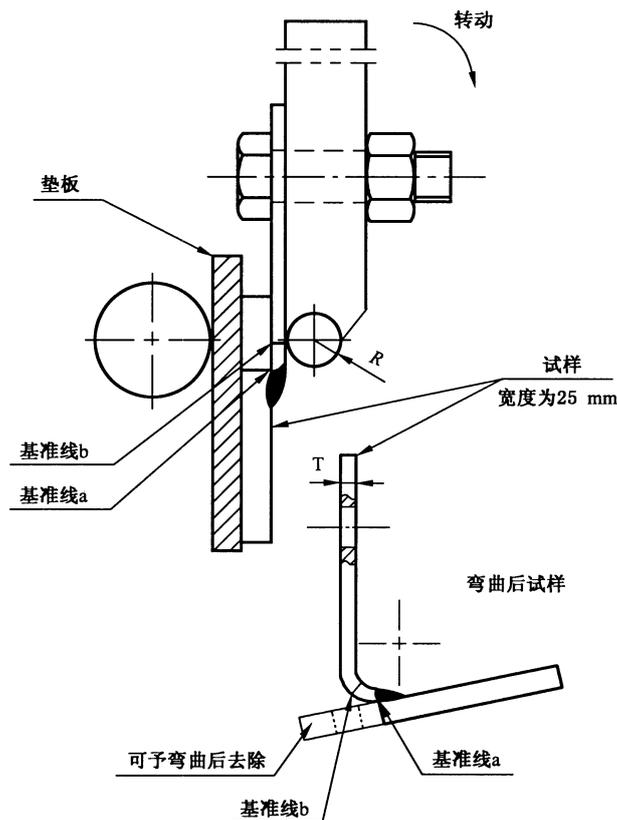
图 16 替代圆形压头弯曲试验
