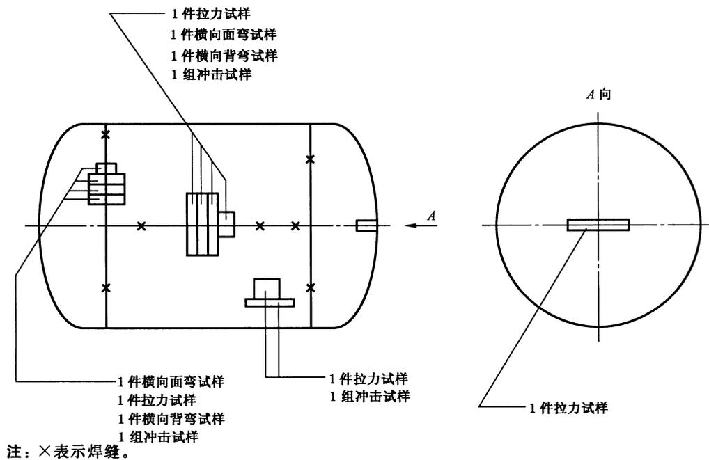
图 11 有纵焊缝钢瓶的取样位置示意图
