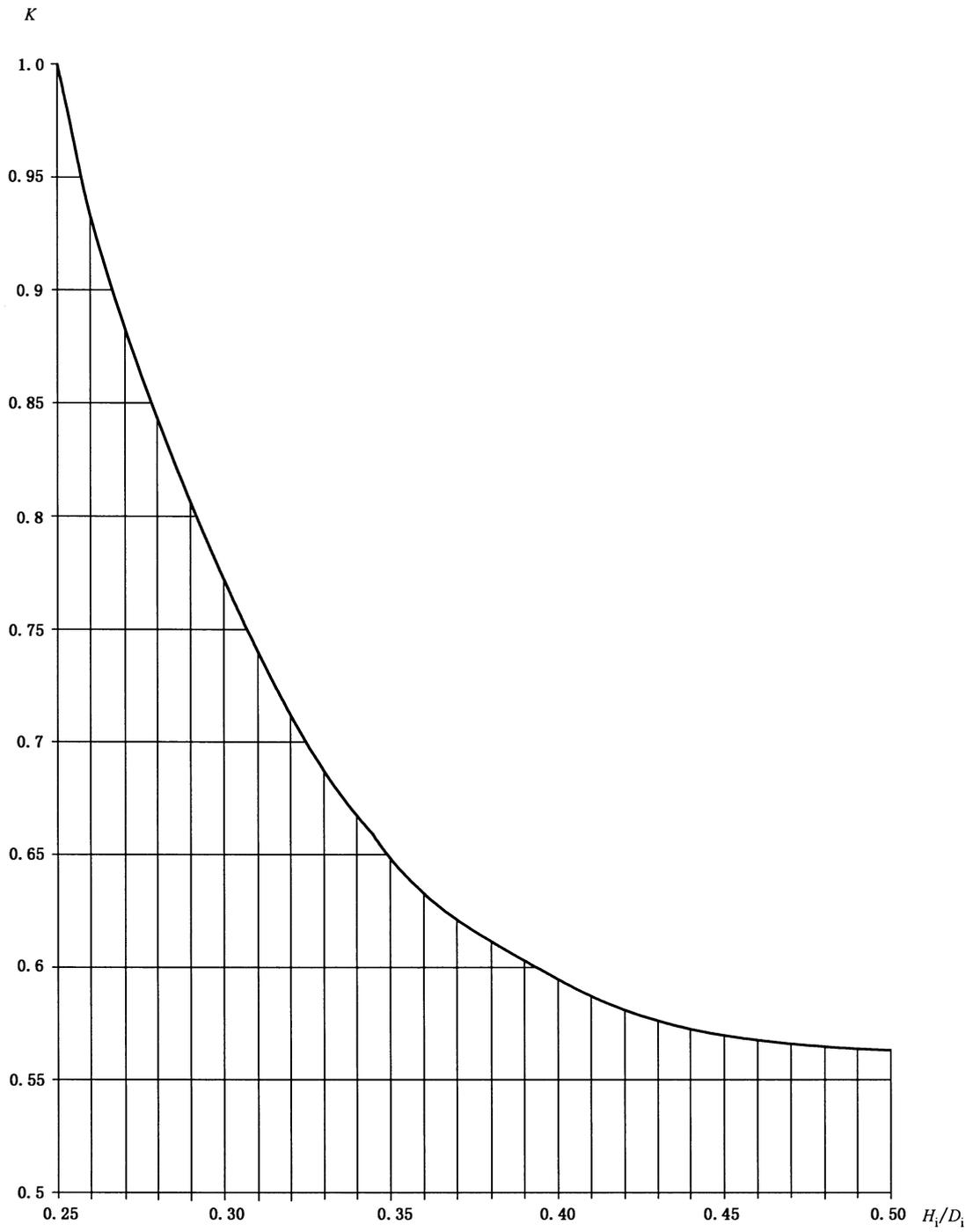
图 3  $H_1/D_1$  在 0.25~0.5 时的封头形状系数  $K$
