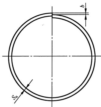
图 7 筒体纵焊缝对口错边量
