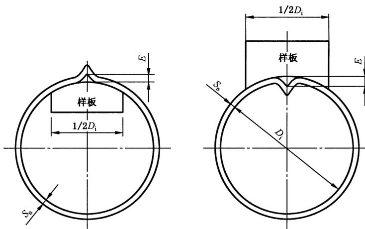
图 8 筒体纵焊缝棱角高度
