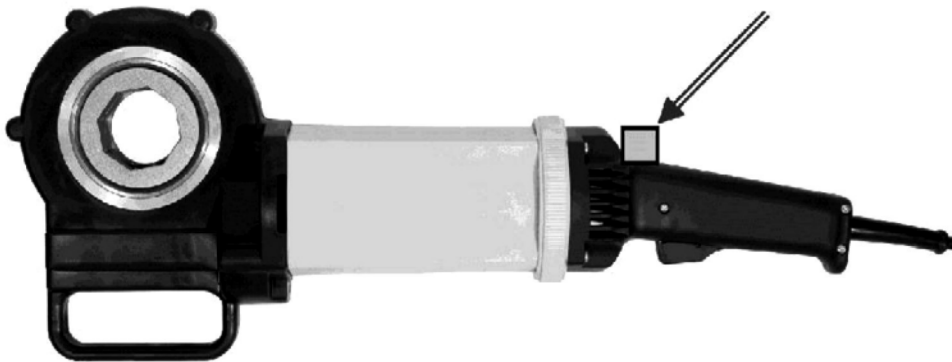
图 I.102 套丝机的传感器位置
