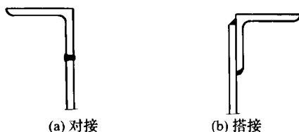
图 6.2.1 包边角钢与罐壁连接接头
